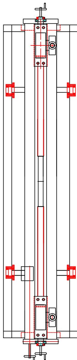
成型机切胶装置示意图
